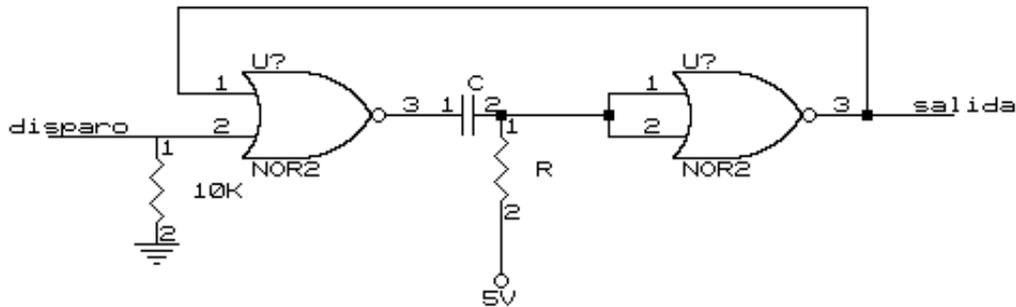
2. Con  $R=10K\Omega$  y  $C=100\mu F$ , generar un impulso positivo en la entrada de disparo y medir el tiempo que dura la salida activada. Calcular el tiempo teórico y comparar los dos valores
