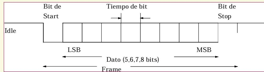
La comunicación es **bidireccional** (dos líneas: TxD y RxD, y GROUND).
