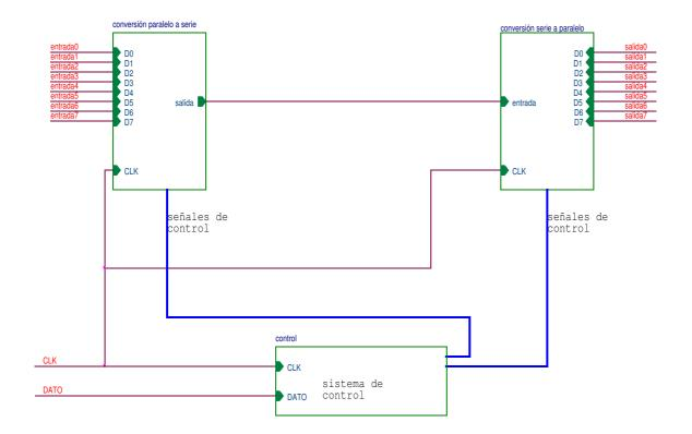
En el, el bloque de la izquierda carga el dato de 8 bits y lo convierte a série, transmitiéndolo en 8 pulsos de reloj por la línea serie. El bloque de la derecha recibe en 8 pulsos de reloj el dato por la línea serie y lo convierte a paralelo sacándolo por las lineas salida7..salida0. El sistema de control genera las señales necesarias para que los dos bloque funcionen correctamente.
