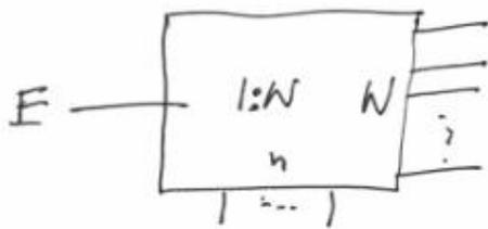
Se utiliza para la deselección de datos, demultiplexación de señales en el tiempo y para realizar funciones lógicas
