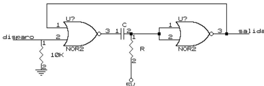
2. Con  $R=10K\Omega$  y  $C=100\mu F$ , generar un impulso positivo en la entrada de disparo y medir el tiempo que dura la salida activada. Calcular el tiempo teórico y comparar los dos valores
